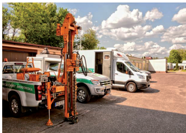
Rys. 8.1. Mobilne laboratoria do szybkiej oceny ryzyka i wiertnica samochodowa do wykonywania nierurowanych otworów w gruncie metodą ślimakową [28]
